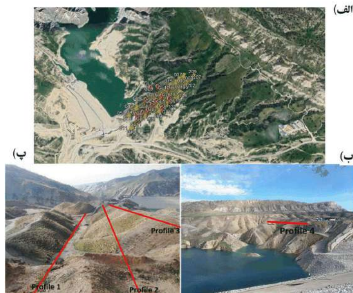
شکل ۳. الف) عکس هوایی از منطقه مورد مطالعه به همراه موقعیت ایستگاه‌های اندازه‌گیری کمیت‌های مقاومت ویژه الکتریکی و پلاریزاسیون القائی و محل گمانه‌ها در نزدیکی پروفیل‌ها، ب) تصویر مخزن سد و توپوگرافی محل برداشت (شمالی شرقی- جنوب غربی)، پ) امتداد پروفیل‌ها در محل تکیه گاه چپ سد و وضعیت توپوگرافی محل برداشت (شمالی - جنوبی).
