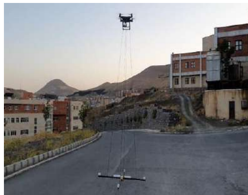
شکل (۲): آرایش صلیبی حسگرهای ممز آویزان شده از پهپاد
